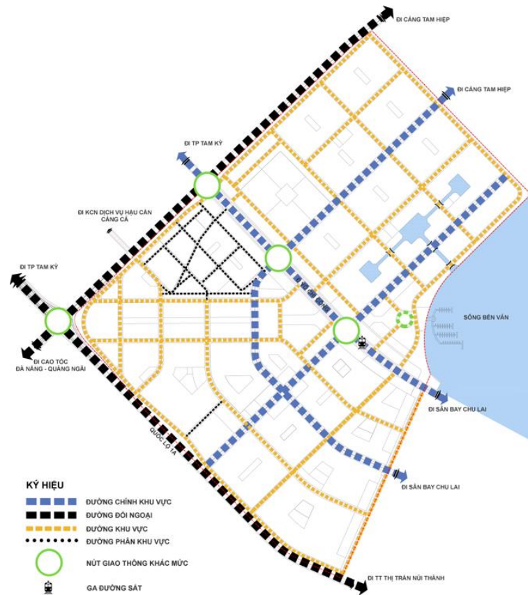
Hình 5.3: Sơ đồ hệ thống giao thông
